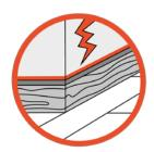
Para conexiones de sellado y juntas con un esfuerzo de tracción moderado, por ejemplo entre hormigón, yeso, fibrocemento, ladrillo, aluminio anodizado, madera y PVC rígido.
